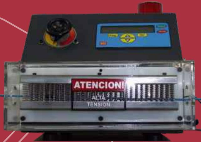
Este equipo se encuentra diseñado para verificar la aislación de conductores eléctricos durante el proceso de fabricación o en fases posteriores de producción.
